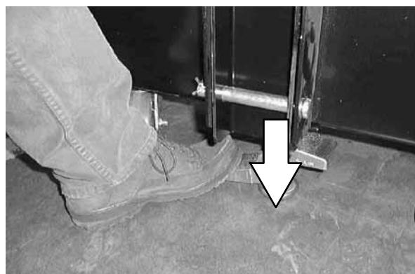
8. Ajuste los rodillos del carrito de la batería antes de extraer las baterías por rodamiento. Los rodillos del carrito de la batería deben encontrarse a la misma altura que los rodillos de la batería de la máquina.
