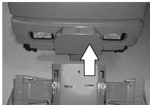
4. Cierre los enganches de la parte delantera del soporte de montaje. Quite el freno de estacionamiento y dirija la máquina a la zona que desea limpiar.
