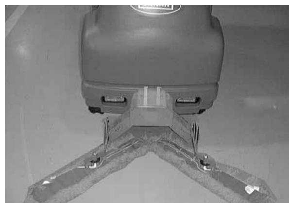
7. Retire y fije de nuevo las tapas del cabezal QuickMop con las fijaciones de extracción fácil. Retire las tapas del cabezal para girar, sacudir y limpiar el cabezal periódicamente.
