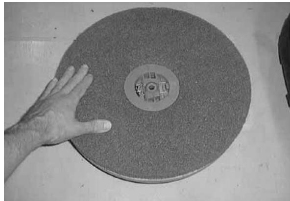
11. Coloque un cepillo de fregado/impulsor de la almohadilla nuevo en el suelo, al lado del cabezal de fregado. Empuje el cepillo hasta situarlo debajo del cabezal de fregado.
