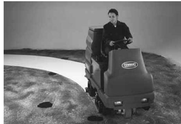
El volante controla la dirección de desplazamiento de la máquina. El pedal direccional controla la velocidad y sentido de desplazamiento de la máquina. El pedal del freno reduce la velocidad y detiene la máquina.
