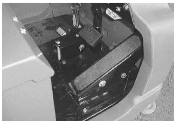
3. Pise el pedal del freno para detener la máquina.
